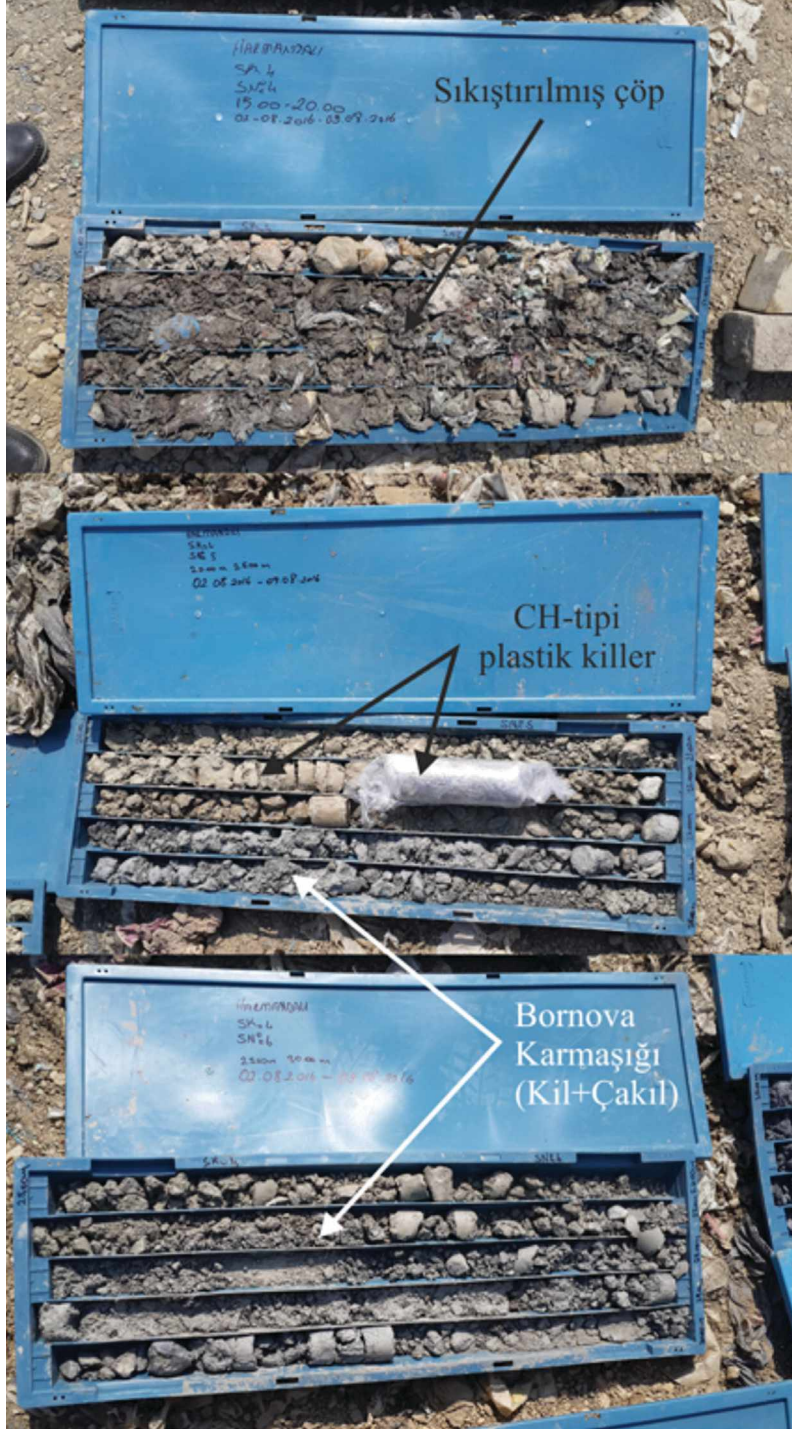
Şekil 9. F_{12} fayının etkisiyle deforme olmuş aglomeratlar ve Bornova Karmaşığı'na ait şeyler.
